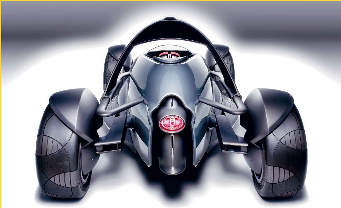
Владимир Пирожков, 2004. Концептуальный двухместный гоночный внедорожник Toyota Motor Triathlon Race Car. У каждого колеса свой электродвигатель. Питание от водородных топливных ячеек
